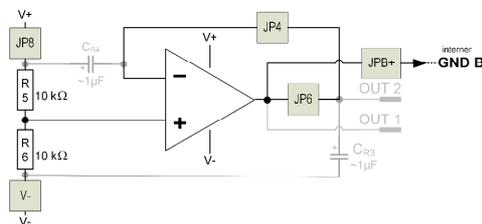
Bei folgenden üblichen Versorgungsspannungen empfehlen wir für R5 und R6 bis 5V  $10\text{ k}\Omega$ , bis 12V  $22\text{ k}\Omega$  und bis 24V  $47\text{ k}\Omega$ .
